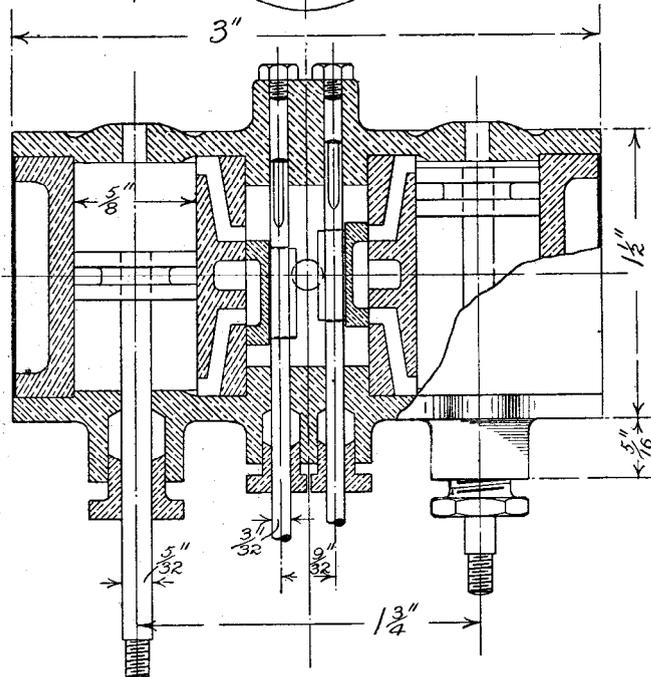
Fig. 35.—LONGITUDINAL SECTION OF CYLINDERS,
